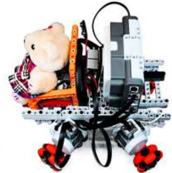
用樂高砌成的聲控輪椅模擬。
